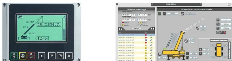
Esempi di display per dispositivo limitatore di momento/carico
