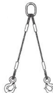
Brache in fune di acciaio con anima tessile e asole preformate con o senza redance, secondo il tipo di applicazione e dimensione.
